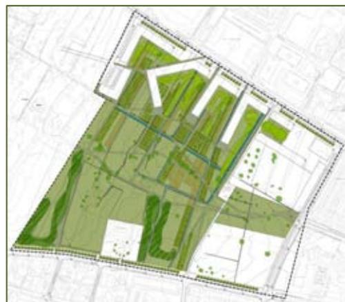
Se han analizado varias alternativas de diseño, proponiendo finalmente una tipología de vivienda en bloque abierto con el fin de que todas las viviendas tengan un buen soleamiento, ventilación cruzada y mayor contacto con el parque.
